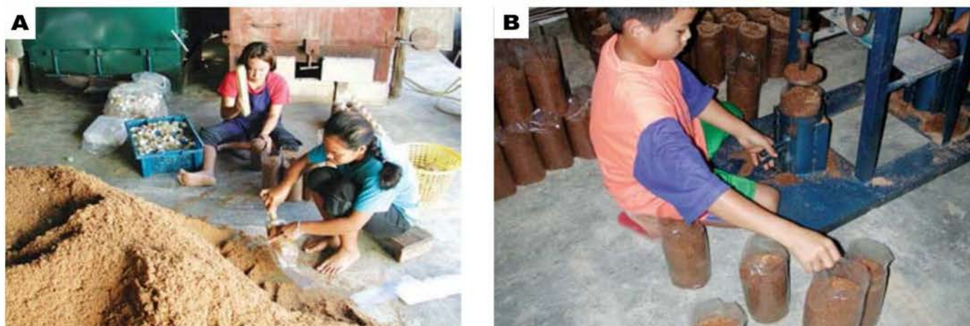
Figura 5. Llenado y compactado de las bolsas A: Llenado manual y compactado con palo B: Compactado de bolsas con una máquina
